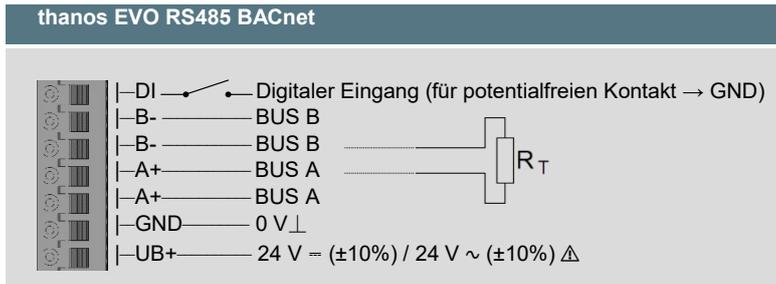
Bei Wechsellspannung muss auf korrekte Polung geachtet werden!
