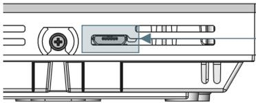
Position des Micro-USB Ports, siehe Unterseite des Geräts, zur Konfiguration mit Bluetooth-Dongle oder Micro-USB-Programmierinterface
