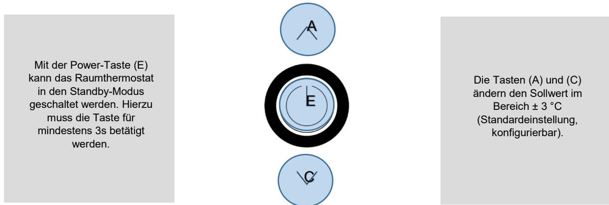
Mit der Power-Taste (E) kann das Raumthermostat in den Standby-Modus geschaltet werden (nicht möglich, wenn die Funktion Keycard-Schalter verwendet wird!). Bei gleichzeitiger Verwendung der Taste als Präsenztaste muss die Taste für mindestens 3s betätigt werden, in allen anderen Fällen reicht eine kurze Betätigung. Im Standby-Modus sind Display und alle Ausgänge ausgeschaltet (Regler deaktiviert). Die Frost- und Hitzeschutzüberwachung bleibt aktiv.
