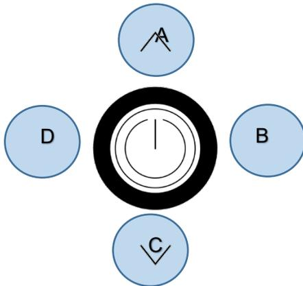
Durch gleichzeitiges Drücken der Tasten „Hoch“ (A), „Links“ (D) und „Rechts“ (B) für mindestens 3 Sekunden wird das Parametermenü aufgerufen.
