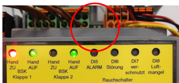
Bild: RDC683, Platz für Steckbrücke zur Bus-Terminierung
